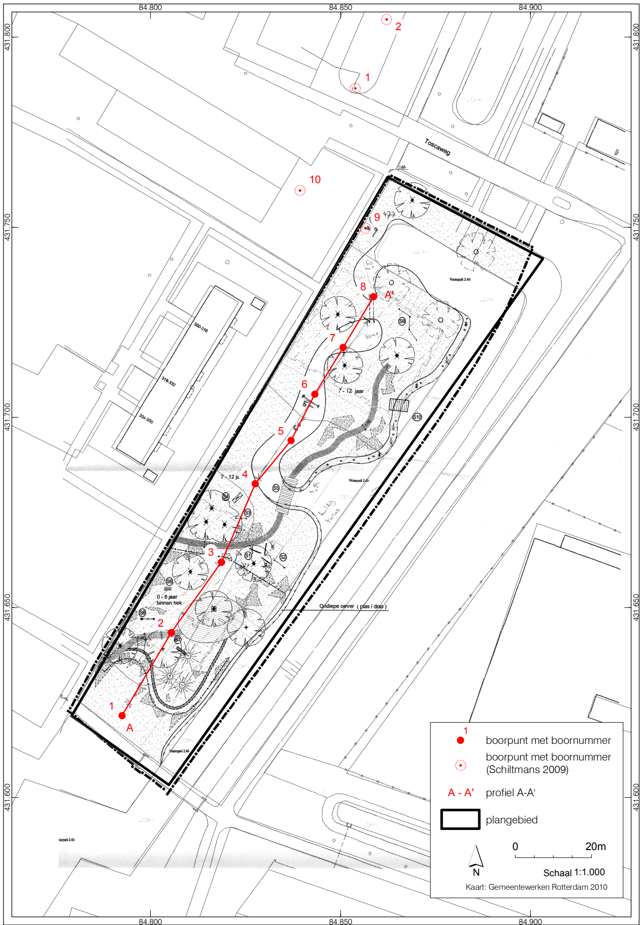
Afb. 3. Ligging boorpunten en profiel A-A' geprojecteerd op de contouren van de te ontgraven waterpartij.
